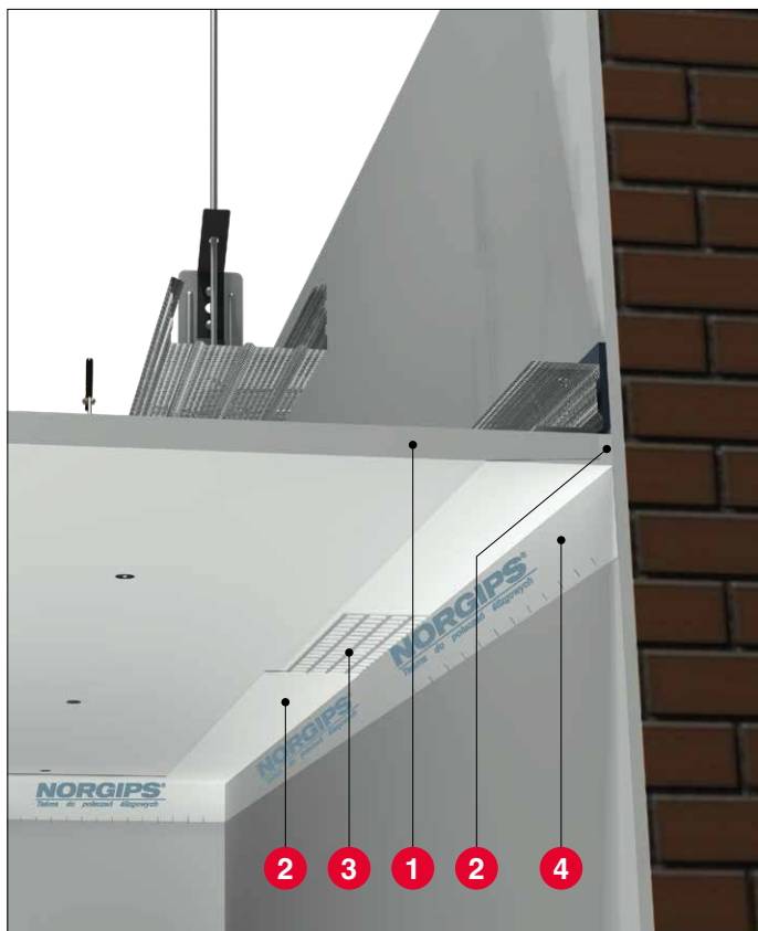
Obr. 5. Dilatační spojení v zavěšeném podhledu
